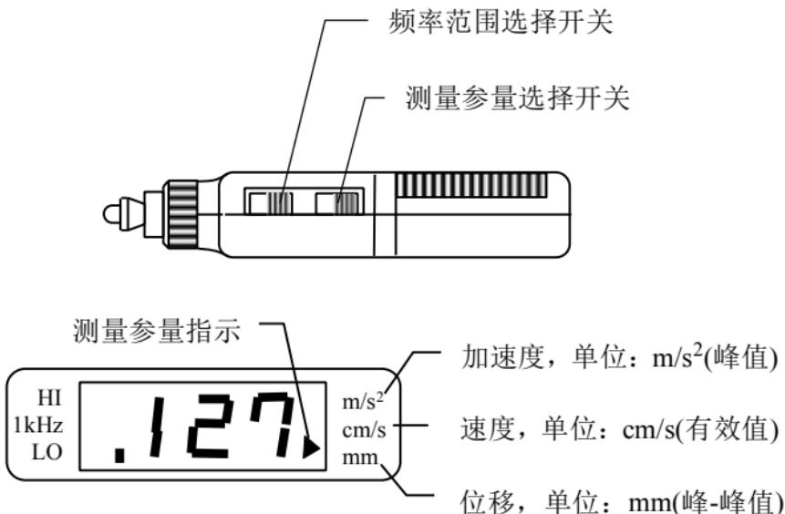
该仪器所测量的加速度单位是  $m/s^2$ 。如果加速度用 G 表示，可将所测量的值除以 9.8 (即  $G=9.8m/s^2$ )。
