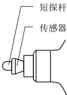
间或其他条件限制，使用短探杆困难时，应使用8厘米长的长探杆。在一般测量时，使用长探杆没有什么问题。但是，高于1kHz时，频率响应下降。因此，在使用“HI”档测量加速度时，应特别小心。
